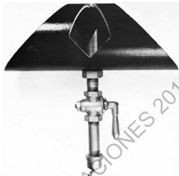
Figura 701 - 5. Dispositivo para el muestreo del asfalto en línea
